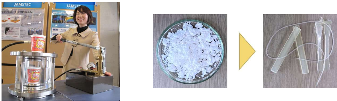
図1. (左) ~1,000気圧までの高圧を発生できるハンドポンプ。(右) 室温でのプラスチックの成形加工。粉末状のバリプラスチックを室温・500気圧で熔融させ、様々な成形品を製造可能です。
